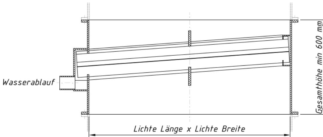
**Ausführung Typ 1-E:** Montage mit beidseitigem Flansch zwischen Lüftungskanälen. Regenwasser wird über inneren Ablaufstutzen abgeleitet.
