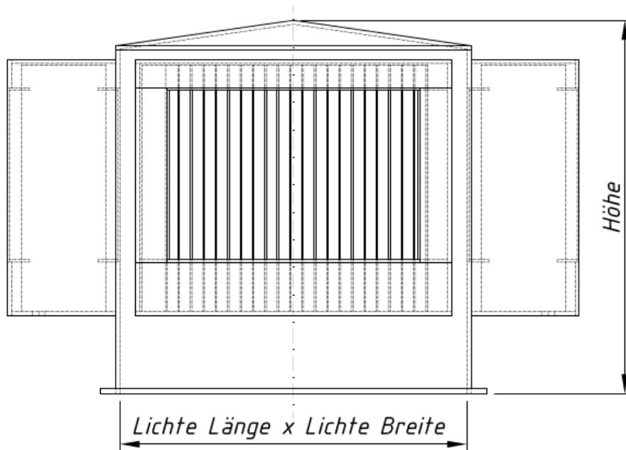
**Ausführung Typ 2-C:** Montage mit Flansch auf einem Lüftungskanal und Auflage auf einem Dachsockel
