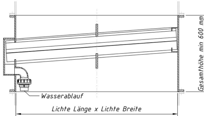
**Ausführung Typ 1-F:** Montage mit Flansch auf einem Lüftungskanal und Auflage auf einem Dachstuhl.
