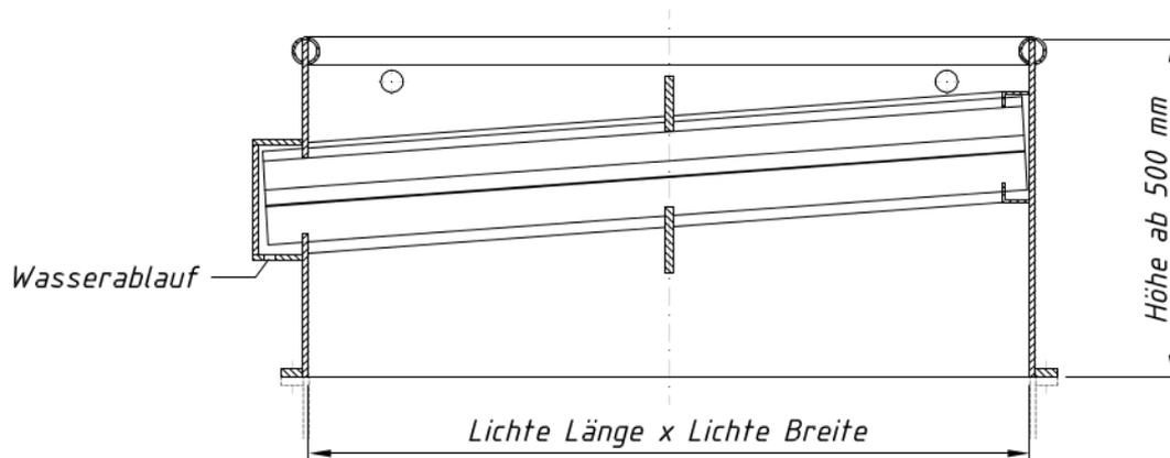
**Ausführung Typ 1-C:** Montage mit Flansch auf einem Lüftungskanal und Auflage auf einem Dachsockel
