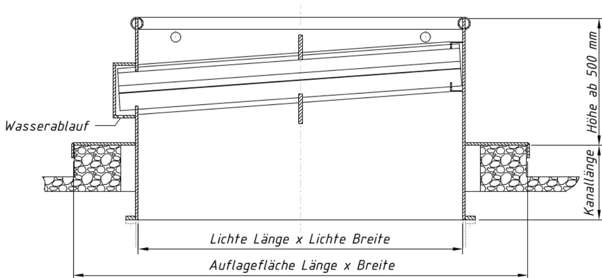
**Ausführung Typ 1-D:** Montage mit beidseitigem Flansch zwischen Lüftungskanälen, Regenwasser wird über äußeren Ablaufstutzen abgeleitet.
